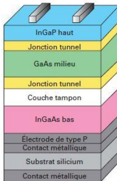
Figure I-6 : vue schématique de la composition de la cellule à multijonction.
