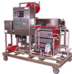
**Figure 10:** Thermoflach pour pasteurisation flash.
