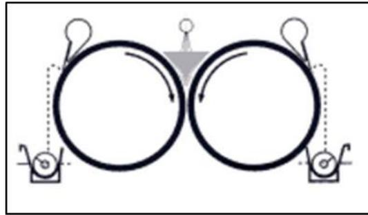
**Figure 13:** Séchage sur cylindres.
