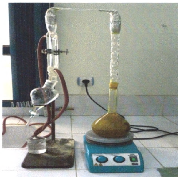
Figure 10 : le montage d'hydrodistillation employé pour l'extraction des huiles essentielles
