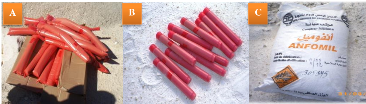
Figure 15 : les différents explosifs utilisés pour abattre le gypse
