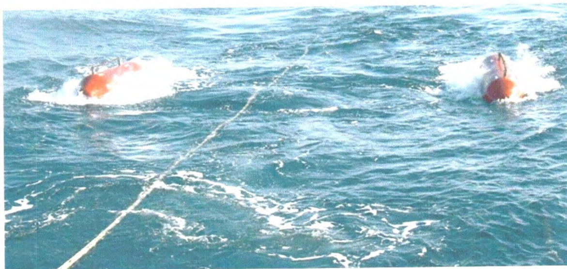
Fig. 7: Dispositif d'acquisition sismique en offshore (flute et canons à air)
