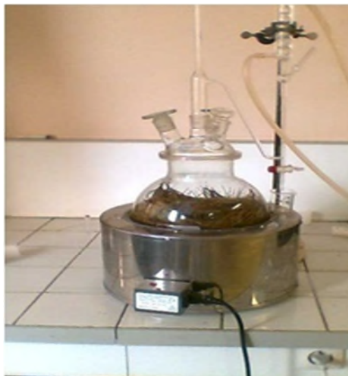
Fig. 26 : Montage d'hydrodistillation (Appareil de type Clevenger selon la méthode préconisée dans la Pharmacopée européenne [4]).
