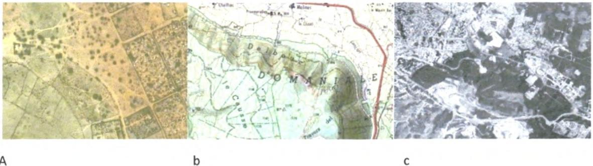
**Fig. 03** : Exemple de quelques données Raster (a : image satellitaire, b : image scannée, c : ortho photo aérienne) [BONNET M. 2012]
