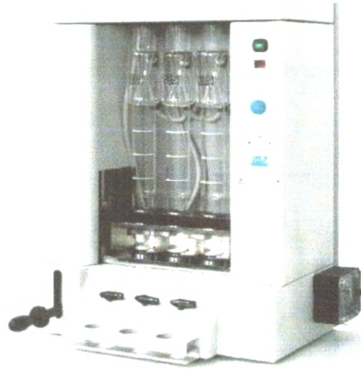
Figure 13: Extracteur de fibres (fibre-test)
