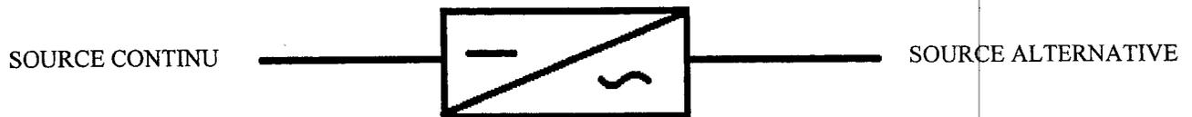
Figure.III.12 : Schéma de principe de l'onduleur
