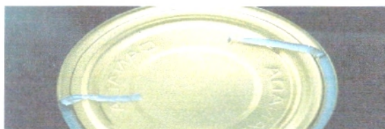
Figure 29 : Jointage élastique défectueux [2].
