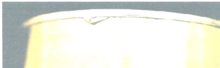
Figure 18 : Bord à sertir déchiré (B.S.D.) [2].
