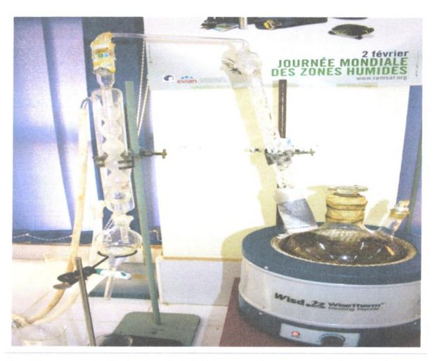
Photo 06: Montage pour l'hydrodistillation « laboratoire N°4 d'Agronomie» (Original)
