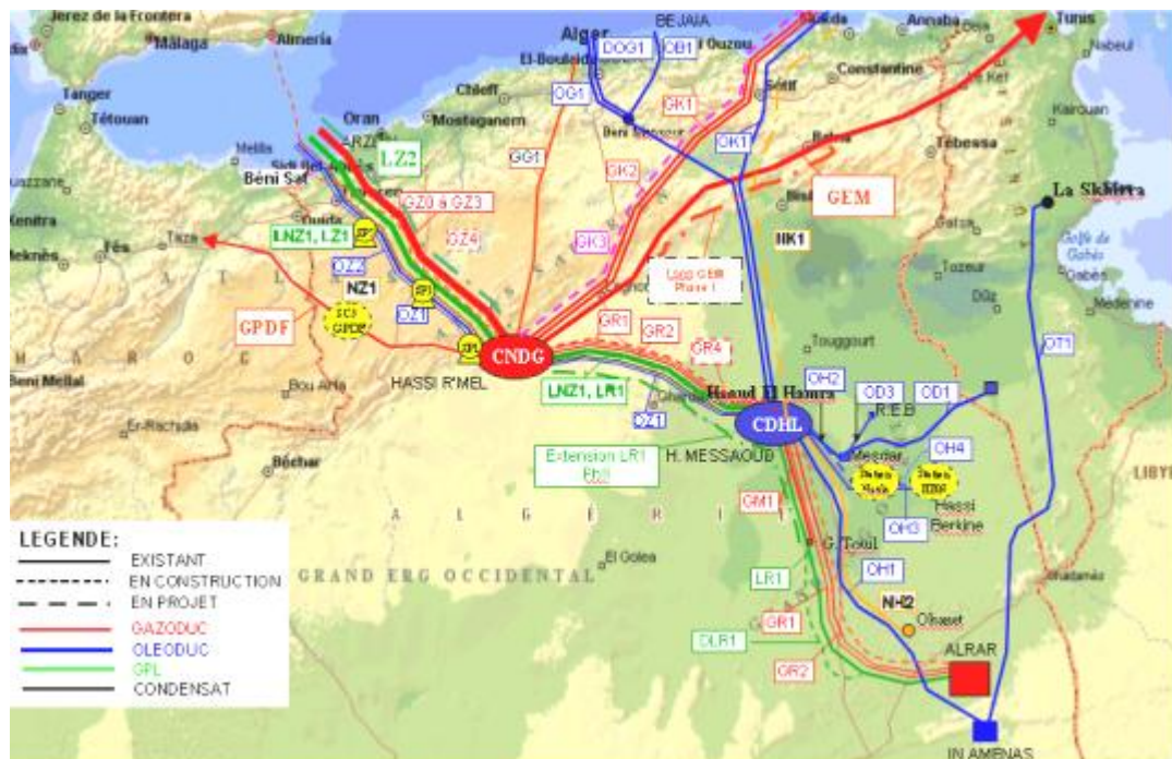
Figure 44 : Réseau de Transport par Canalisation
