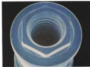
Figure 63 : connexion hexagonale externe.
