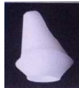
Figure 24 : Infrastructure transviscée CFAO en zircone
