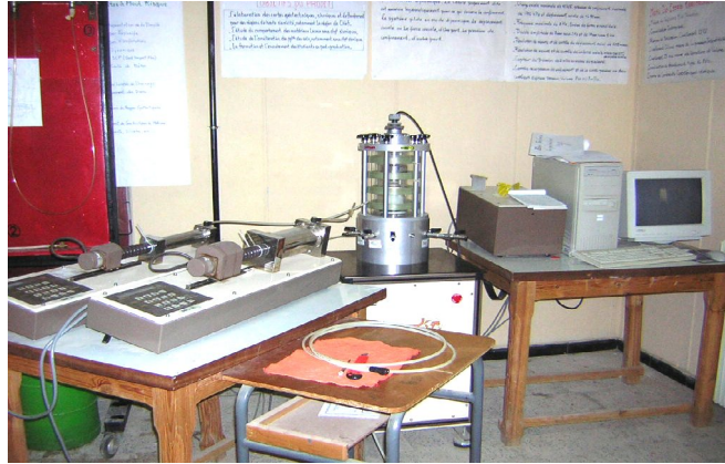
Figure 1. Dispositif expérimental: vue d'ensemble de la cellule triaxiale, Deux contrôleurs GDS et chaîne d'acquisition.
