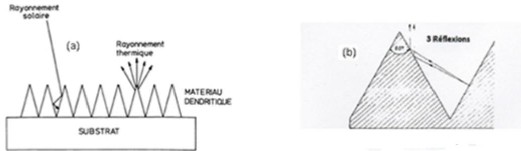
**Figure. 4. c.**Réflexion multiple sur un macroprofil en dent de scie [9]
