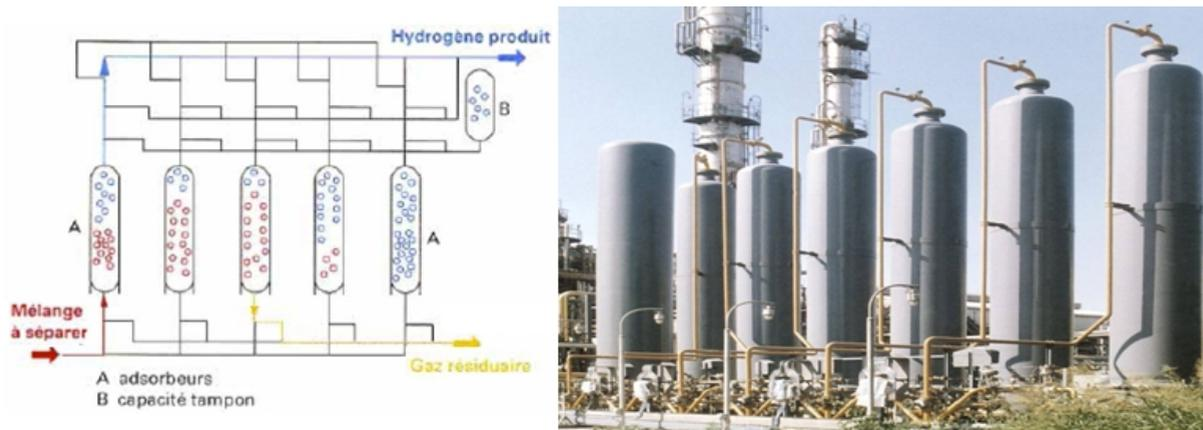
**Fig. VII.4 Schémas et la figure d'une unité de PSA.**
