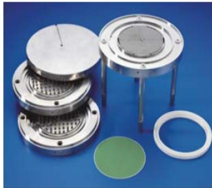
**Fig. V.1 Les différents éléments d'une cellule céramique expérimentale d'électrolyse à haute température EHT développée dans le cadre du projet GENHEPIS.** Réalisé au centre CEA de Grenoble sur le principe d'une pile à combustible SOFC inversée, l'empilement est constitué de membranes céramiques (en blanc) et d'électrodes (en vert).
