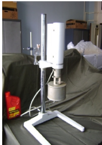
Figure II. 3 : Tête de mesure du rhéomètre HAAKE RV 100 [3]
