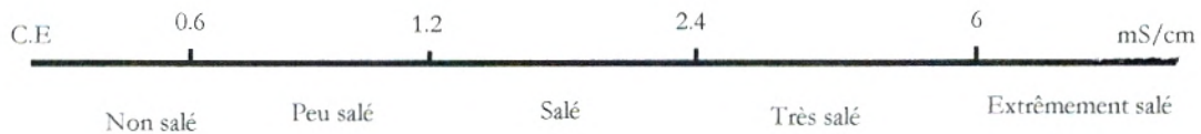
Fig 13 : Echelle de salure en fonction de la conductivité de l'extrait aqueux au 1/5 : relation de Richards in Aubert (1978)
