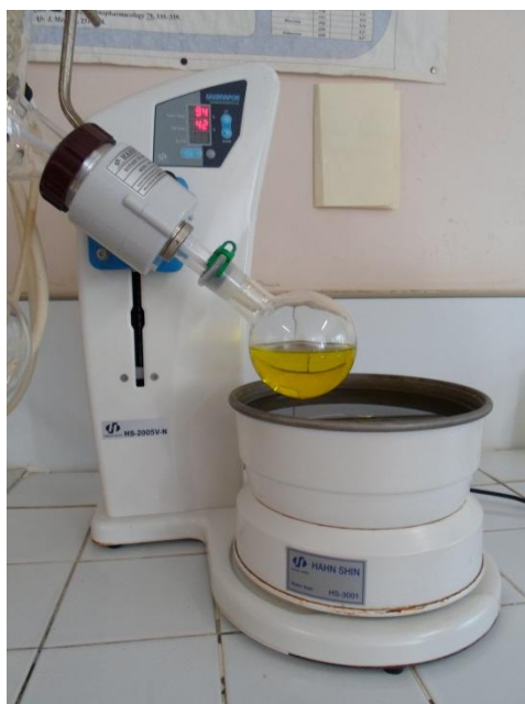
Photo 2 : Evaporateur rotatif de type HAHNVAPOR HS-2005V-N
