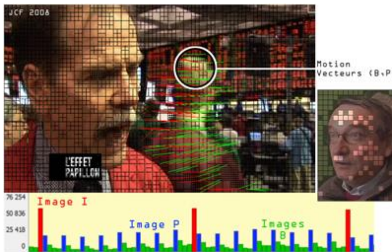
Un flux H264 avec une structure variable selon la complexité de la scène (blocks et macroblocks), et des GOP à structure variable
