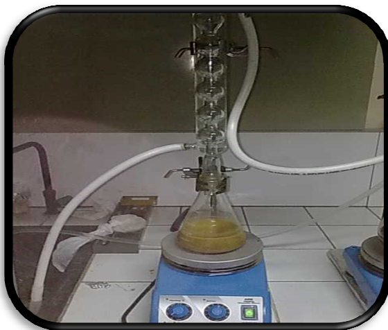
Figure 4: Extraction à reflux
