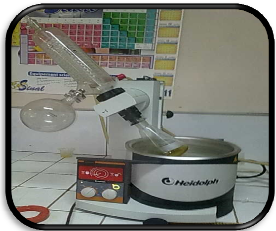
Figure 5: Rota Vapor : Evaporation à sec
