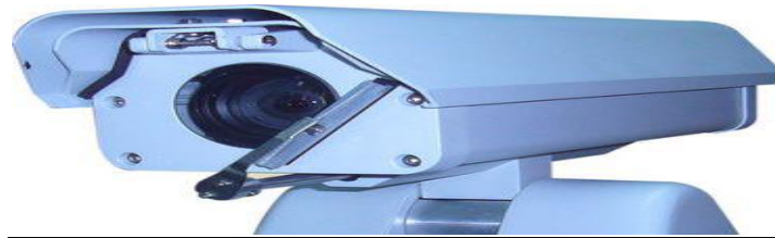
Figure 1. 6 - Caméra Boîtier extérieur équipée d'un essuie-glace
