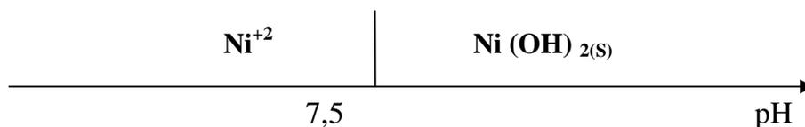
Schéma 2. Formes d'espèces de Ni(II) en fonction du pH
