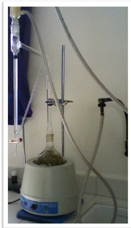
Figure 8. - Montage d'hydrodistillation au laboratoire d'Agronomie à l'université de Tlemcen (original)
