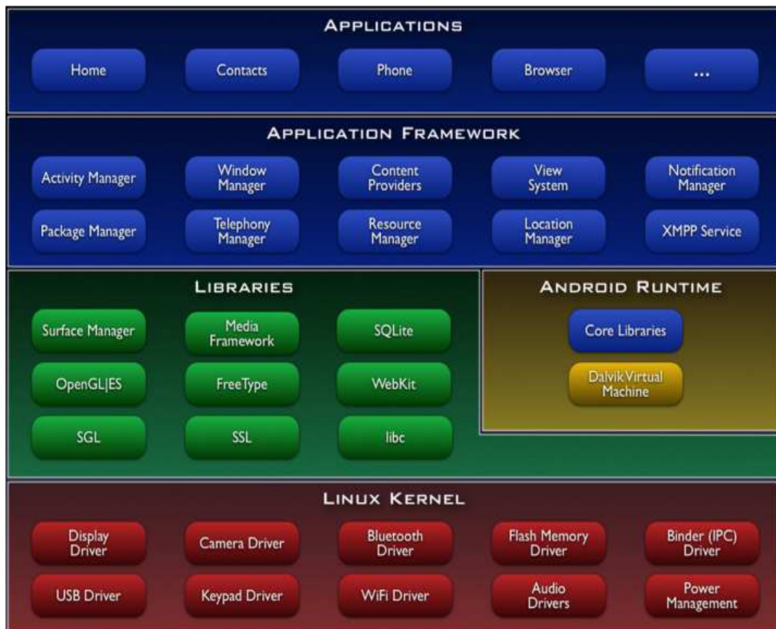
Figure 2 : Architecture de la plateforme Android
