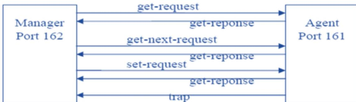
**Figure 1.3** : Exemple d'échange SNMP
