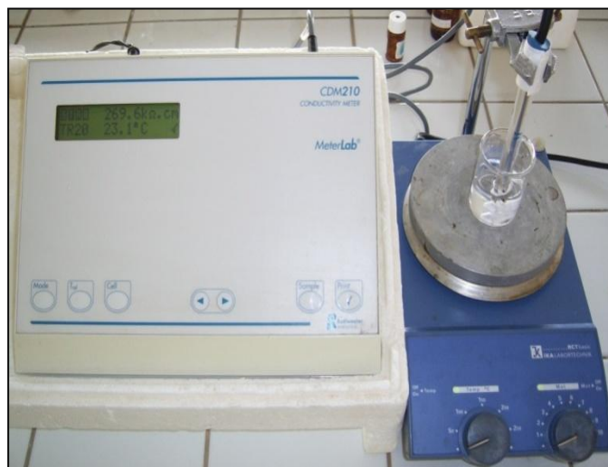
Figure III.6: Conductimètre utilisé avec sa cellule électrolytique
