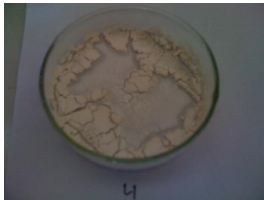
Figure IV.16 : Préparation de membrane à base de CDA par évaporation de solvant
