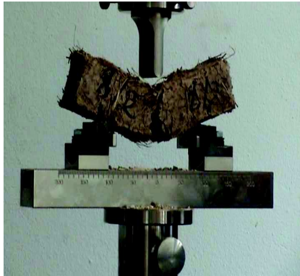
Figure 1. Essais de flexion d'une éprouvette à base de diss à matrice argileuse
