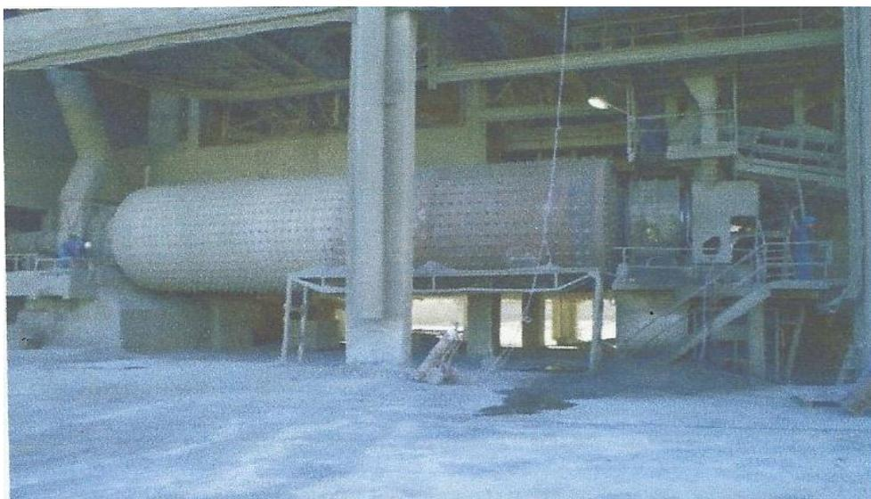
**Figure 1.17.** Broyeur à ciment
