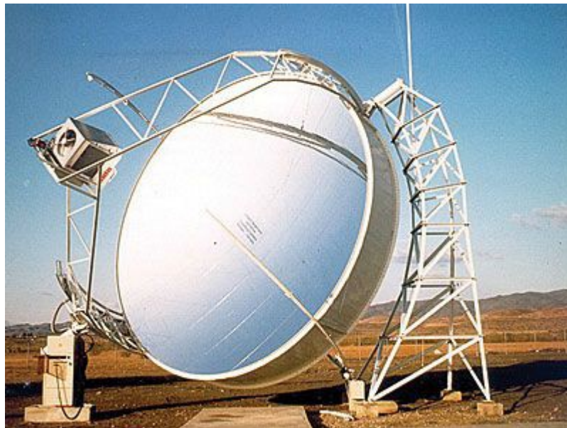
Figure II.13 : Capteur parabolique avec moteur stirling
