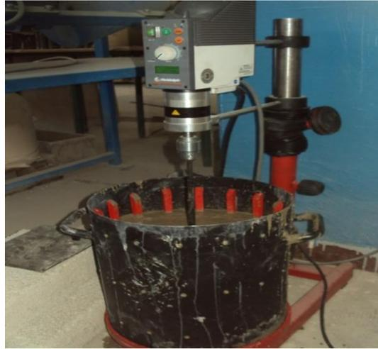
Figure 4.14. Rhéomètre utilisé pour les essais rhéologiques.
