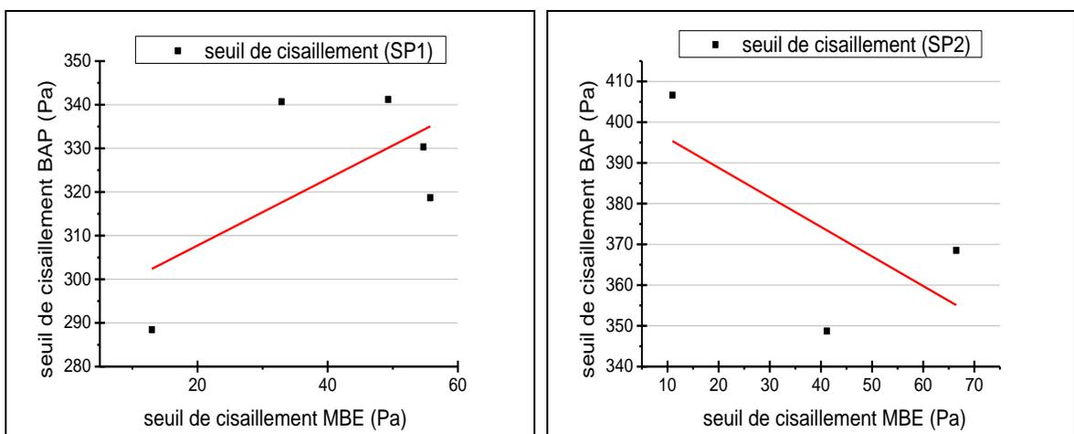
**Figure 4.28.** Relation entre seuil de cisaillement du BAP/MBE.
