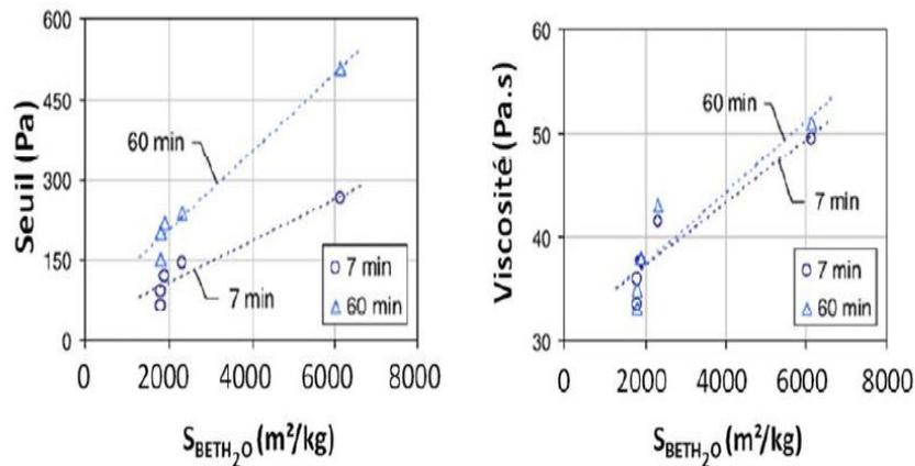
**Figure 2.2.** Evolution des propriétés rhéologiques des BAP en fonction de la surface spécifique des fillers calcaires (Esping, 2008).
