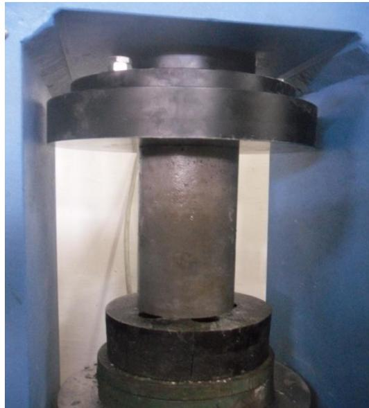
**Figure 4.19.** Essai de compression
