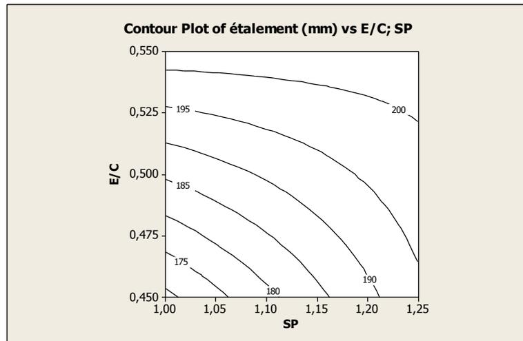
**Figure 4.6.** Iso-réponse de l'étalement de la pâte de ciment en fonction du rapport E/C et le dosage en superplastifiant.
