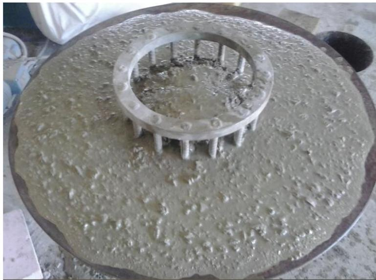
**Figure 4.13.** L'instabilité du béton (essai J-RING).
