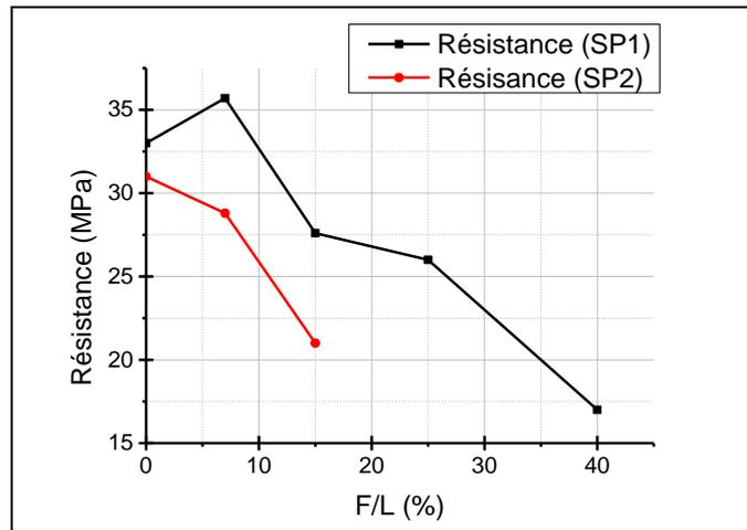
**Figure 4.20.** Résistance à la compression à 28 jours en fonction du pourcentage de fillers. Les résultats montrent que la résistance a tendance à diminuer en augmentant le taux de substitution. Cette substitution partielle du ciment par des fillers calcaires a un effet positif sur les propriétés rhéologiques de la pâte. Si le critère de résistance est imposé, un dosage maximal de 7% de fillers peut être suffisant.
