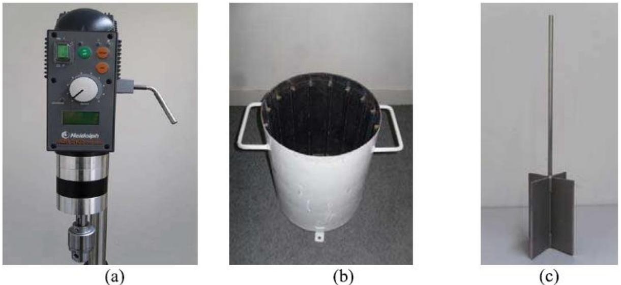
**Figure 1.7.** Composants du rhéomètre (Soualhi et col, 2012).
