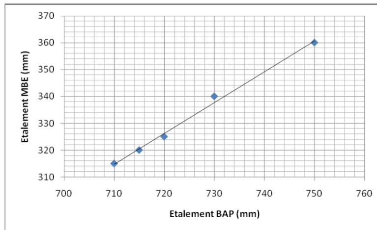
**Figure 1.13.** Corrélation entre étalement MBE/ étalement BAP (Haifi, 2011).
