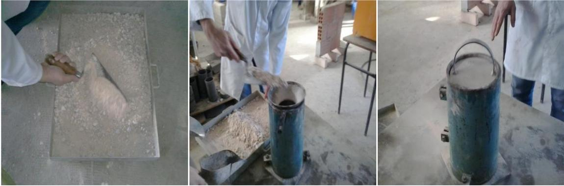
**Figure 4.1.** Mode opératoire pour l'essai de compacité.
