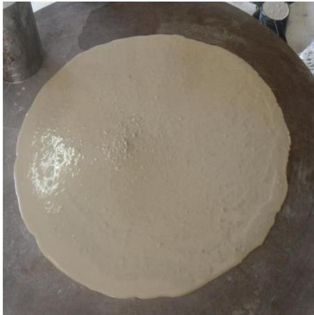
Figure 4.23. Manifestation d'instabilité du mortier.
