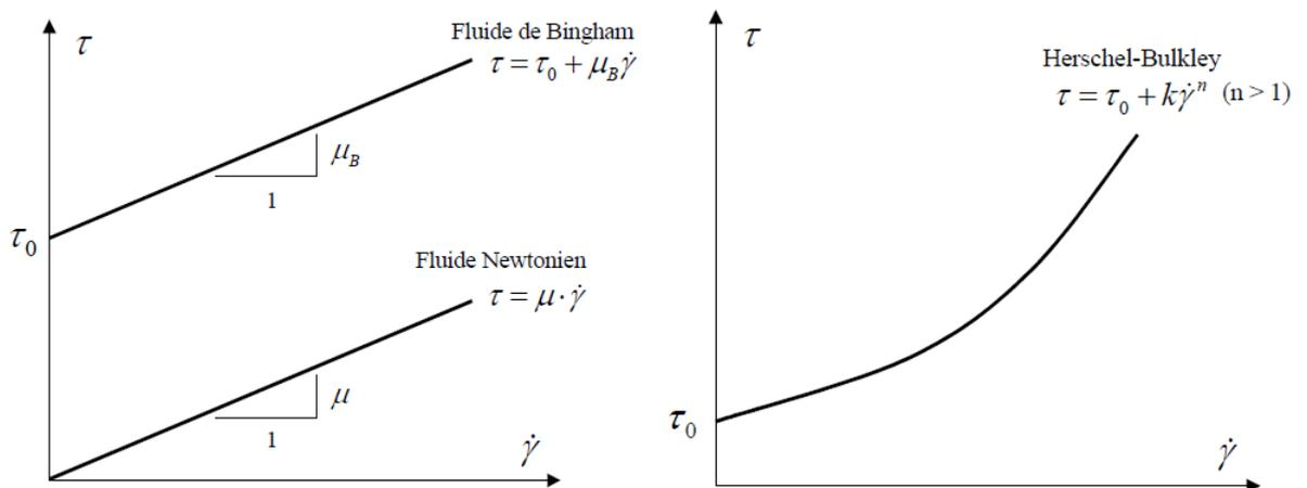
**Figure 1.6.** Les différents types de modèles d'écoulement.
