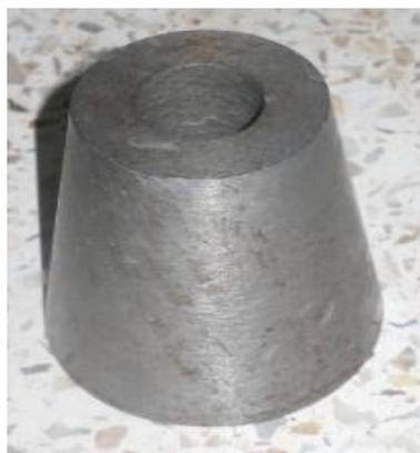
**Figure 4.3.** Mini-cône
