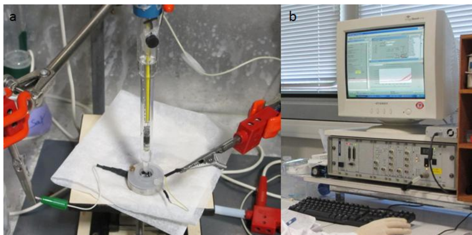
Figure. IV. 8. Dispositifs utilisés pour l'étude électrochimique a) Micro cellule électrochimique, b) Potentiostat Autolab (Eco Chemie).
