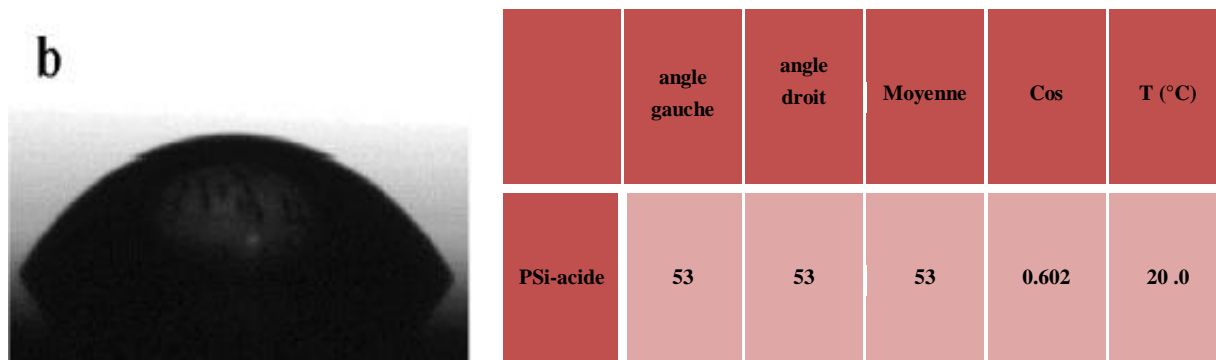
Figure. III. 11. Photographie de 1\mu\text{L} d'une goutte d'eau déposée sur la surface du SiP après greffage de l'acide.
