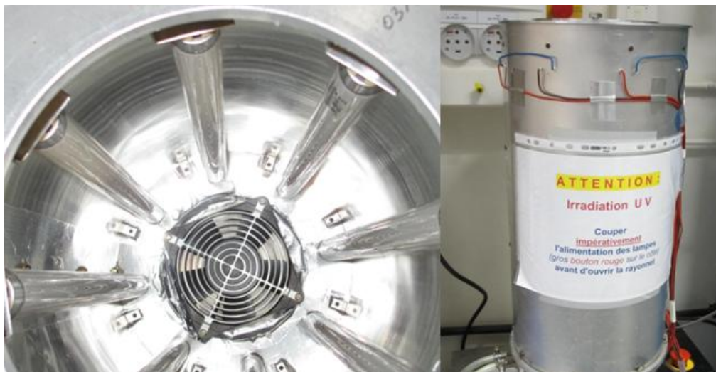
Figure. III. 7. Photographie du réacteur UV utilisé pour le greffage photochimique. a) une vue d'intérieur b) une vue d'extérieur
