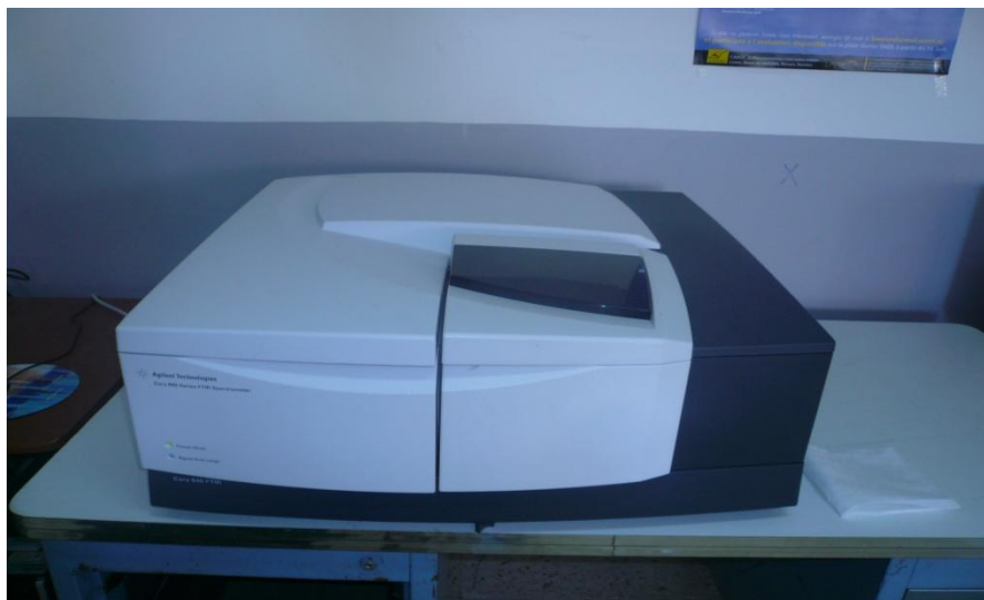
Figure II.5 : Spectroscopie Infrarouge à Transformée de Fourier (FTIR) (cary 640 FTIR Spectrometre).
