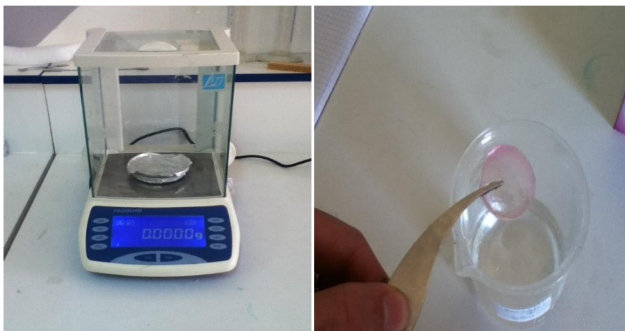
Figure III.1 : Dispositif utilisé pour l'étude du gonflement des réseaux de polymères dans différents solvants.
