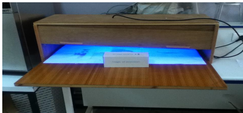
Figure II.2: Dispositif de photo-polymérisation UV
