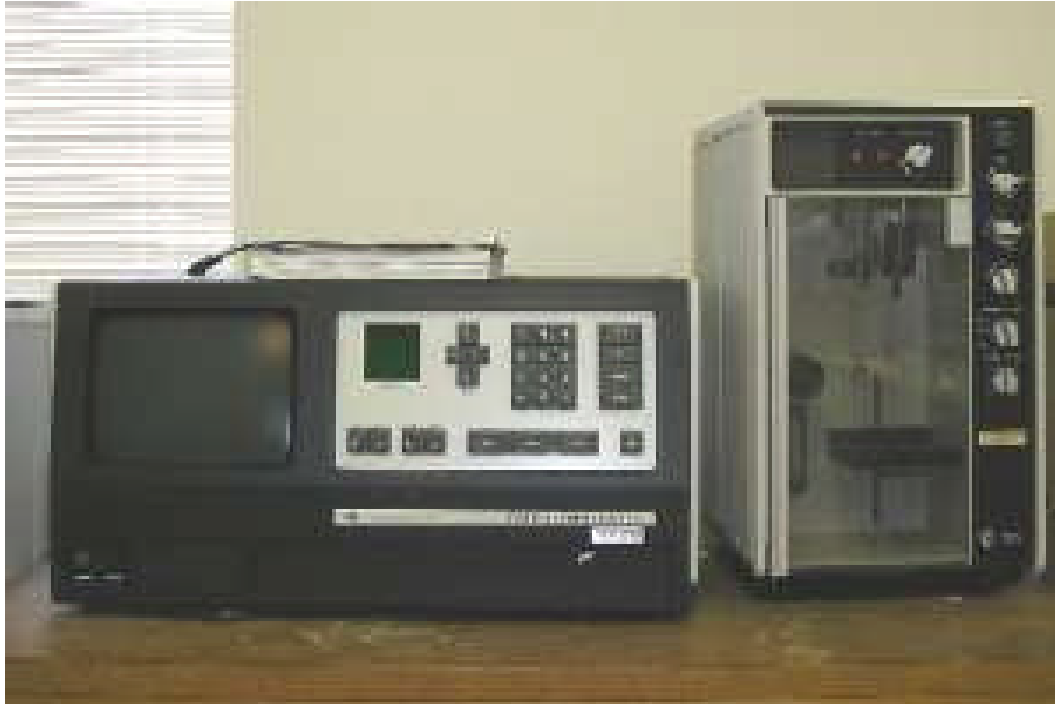
Figure 4.10. Compteur de particules Coulter Mutisizer II
