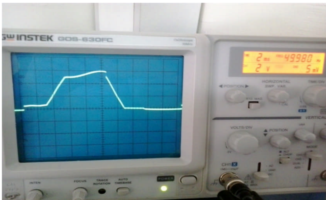
Figure 3.5 [Point N° 01] : Mesure de la tension à la sortie du pont de diodes [6 V]
