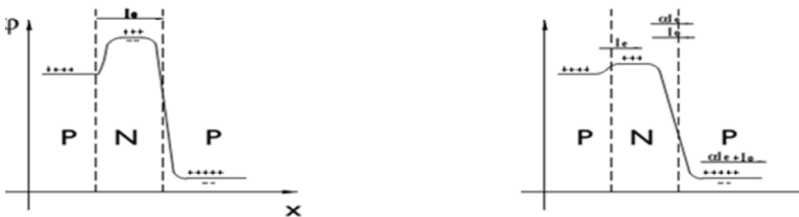
Figure 2.20 : Distribution des potentiels avec émetteur libre. Figure 2.21 : Idem avec un circuit émetteur relié [15].
