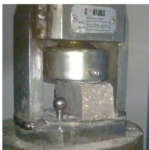
Figure 4.17 : Dispositif de compression
