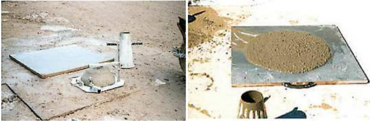
**Figure 1.7** : Essai d'affaissement au cône d'Abrams.
