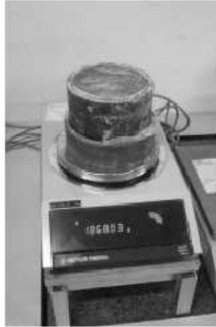
Figure 2.25 : Mesure de l'évaporation.
