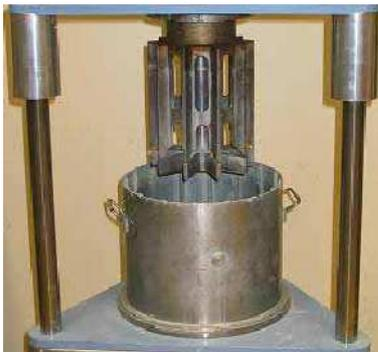
(a) : Rhéomètre BML à cylindres coaxiaux
