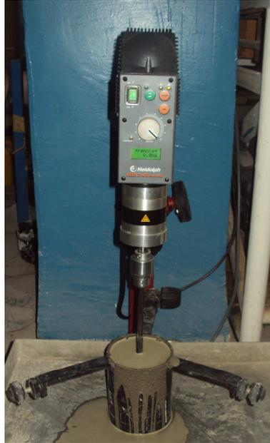
**Figure 4.9** : Essai rhéologique sur mortier.
