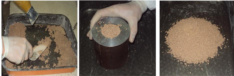
**Figure 3.3 :** La méthode utilisée pour la détermination du coefficient d'absorption du sable.
