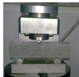
Figure 4.18 : Dispositif de flexion
