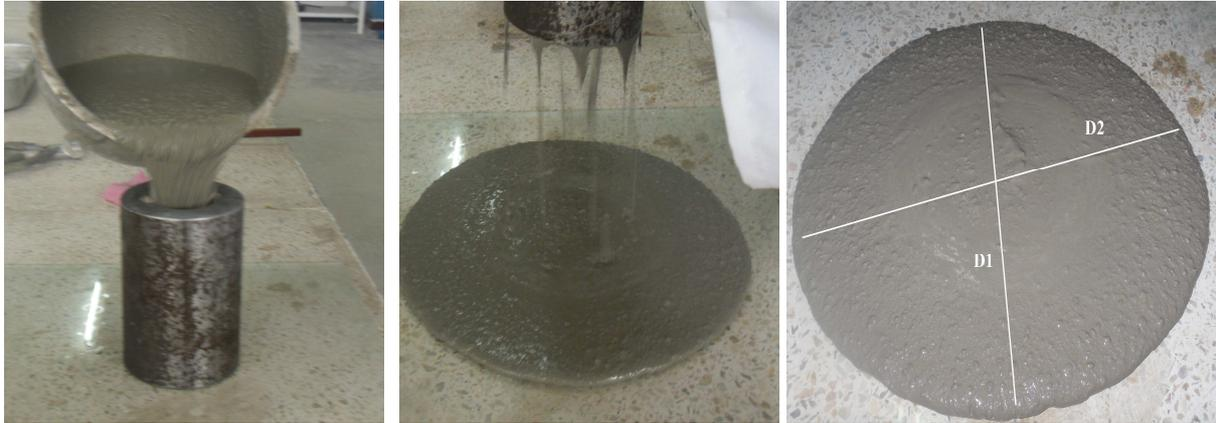
**Figure 4.7** : Etalement des MBE, MBAP et MT au cône.
