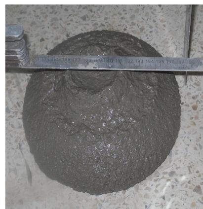
Figure 4.21 : Affaissement au mini cône.
