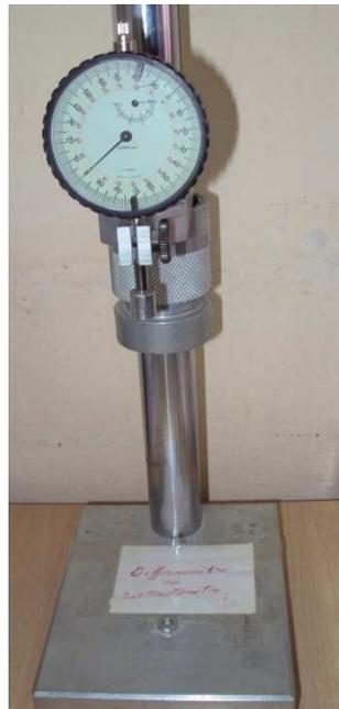
**Figure 2.10** : Le rétractomètre pour la mesure linéique.
