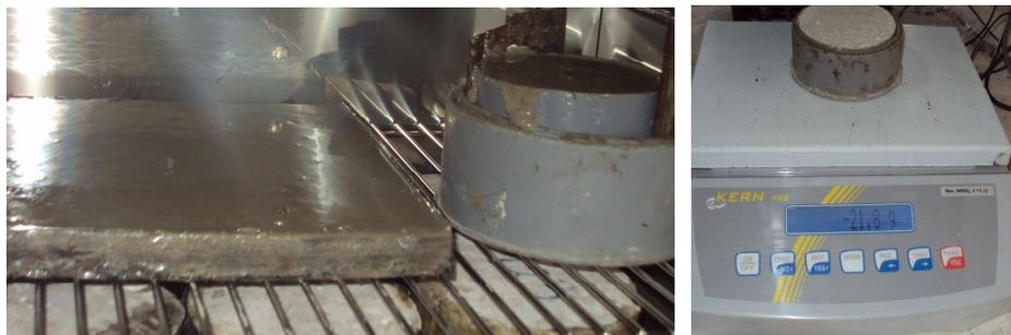
Figure 4.16 : Banc d'essai pour la mesure du taux d'évaporation
