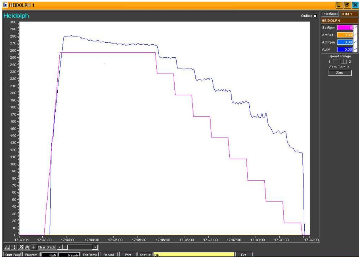
**Figure 4.10:** l'allure de la vitesse imposée (rouge) et des couples de rotation nécessaires (bleu) pour un des mortiers étudiés.
