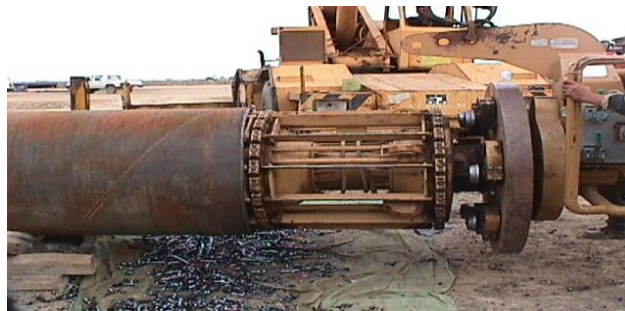
Figure 2.7 : coupe et chanfrein des pipes (STT)
