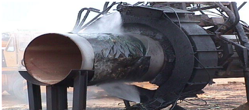
Figure 2.9 : revêtement d'un tube de type thermodurcissable (STT)
