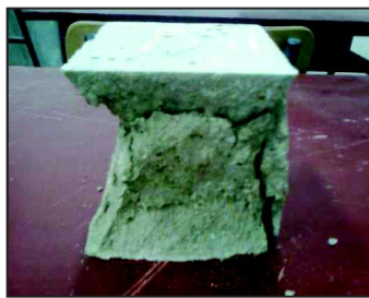
8. A/ béton témoin
