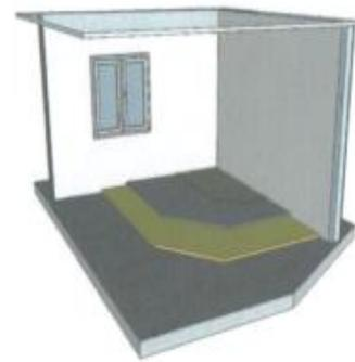
panneaux d'isolants sont disposés sur la dalle puis une chape béton (béton de chanvre) est ensuite coulée sur ces panneaux
