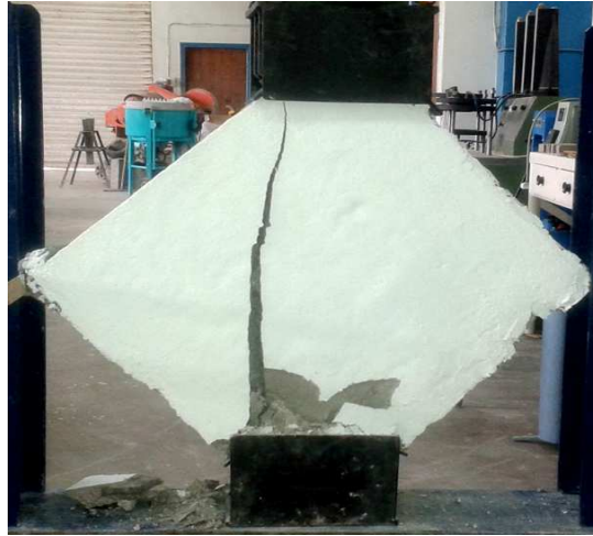
Figure 4.5 : Rupture du mur enduit
