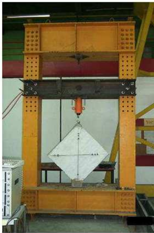
Figure 2.16. Montage expérimental pour l'essai de cisaillement (Gabor, 2006)
