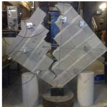
Figure 2.22 Résultat obtenu des écrasements des murs (Vasconcelos, et al., 2012)
