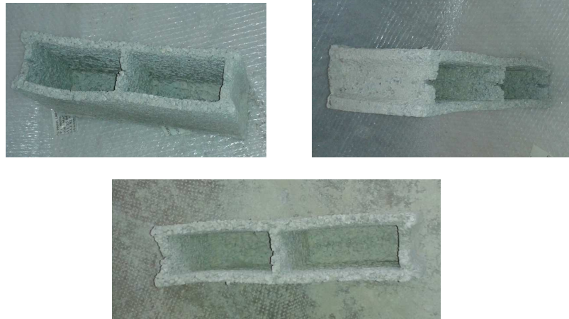
Figure 3.3 Exemple de parpaings tordues et gonflées
