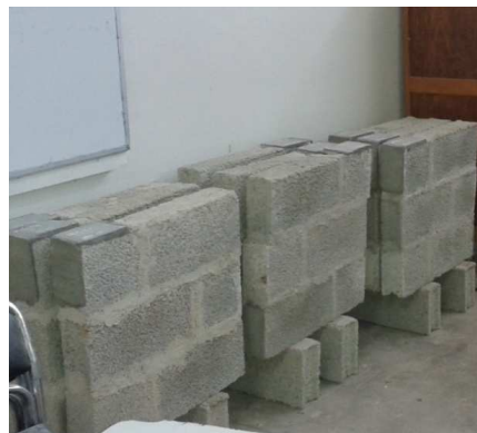
Figure 3.17 Cure et stockage des murs
