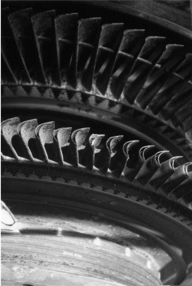
**Figure I-15 : une turbine à gaz 1970 conçu avec laçage fil pour amortir les secondes aubes de turbine en scène. Notez l'aube de turbine 1er étage creux indiquant refroidissement des aubes et la corrosion, tant sur le 1er et les lames 2ème étape.[5]**
