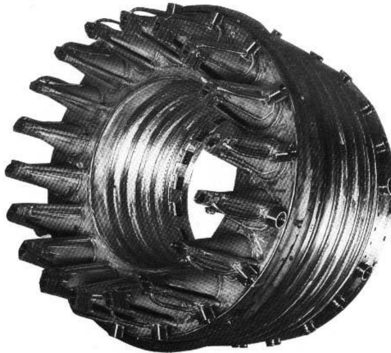
**Figure I-14 : La faible émission de NOx, en double-cône, la conception du brûleur EV est utilisée à la fois dans la GT10 (25 mégawatts) et la GT35 (17 mégawatts) de turbines à gaz. [5]**
