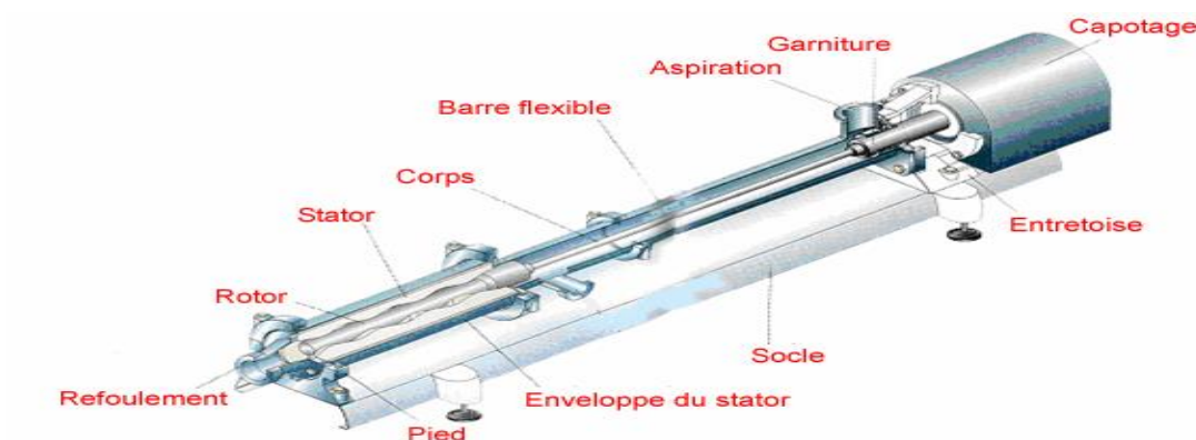
Figure III.10. Éclaté d'une pompe Moineau
