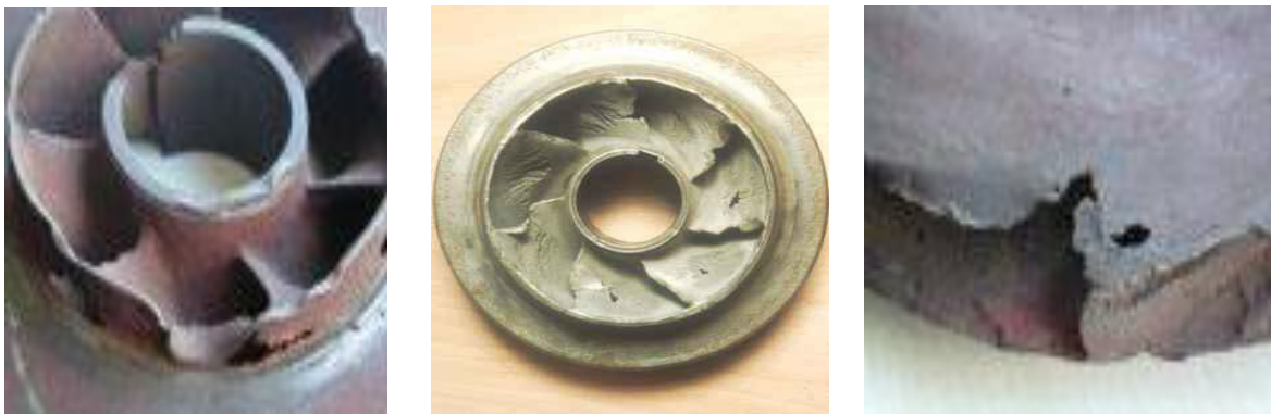
Figure III.29. Roues endommagés par le phénomène de la cavitation
