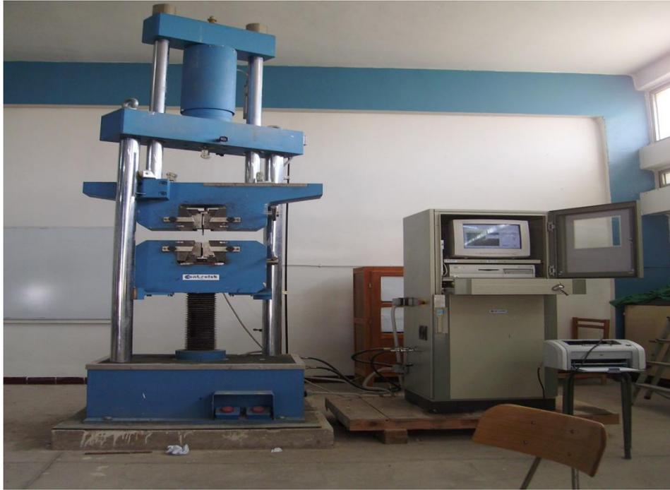
**Figure 24 :** Machine de traction universelle type CONTROLAB (laboratoire de matériaux de la faculté de technologie de l'Université de Tlemcen)
