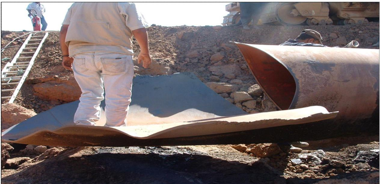
**Figure 17** : Eclatement d'un tronçon de pipe de la ligne GZ1 par fissuration
