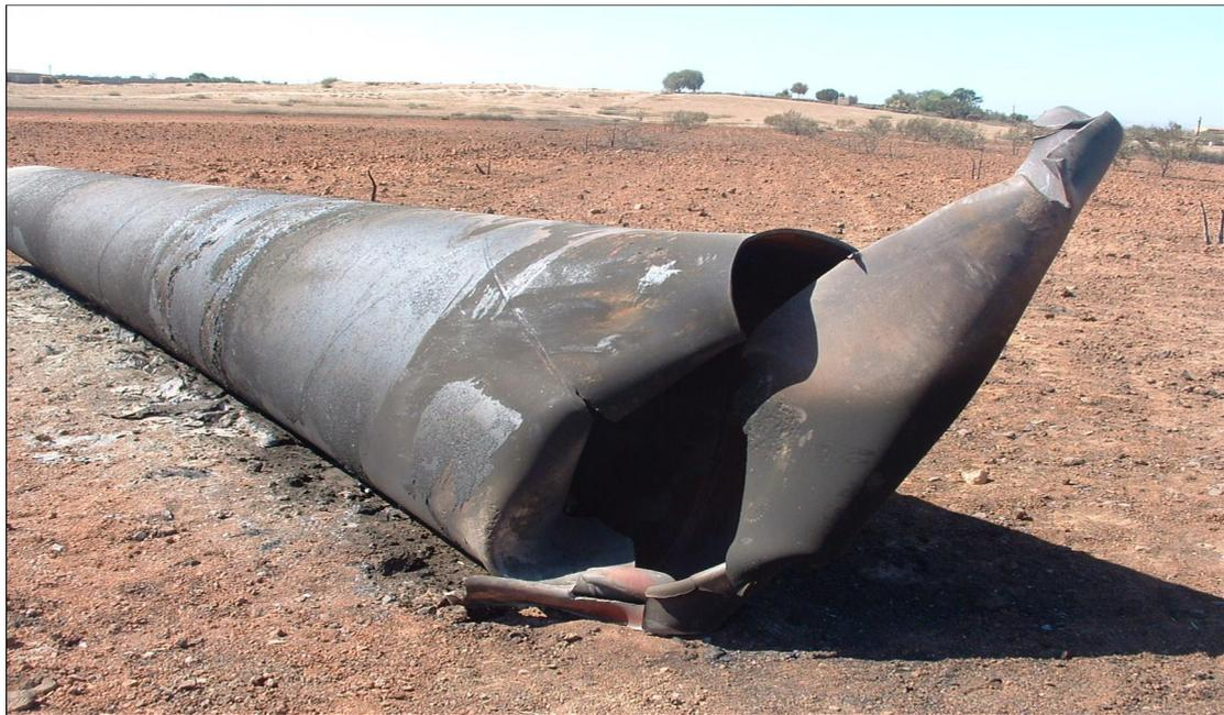
**Figure 16 : Eclatement d'un tronçon de pipe de la ligne GZ1**
