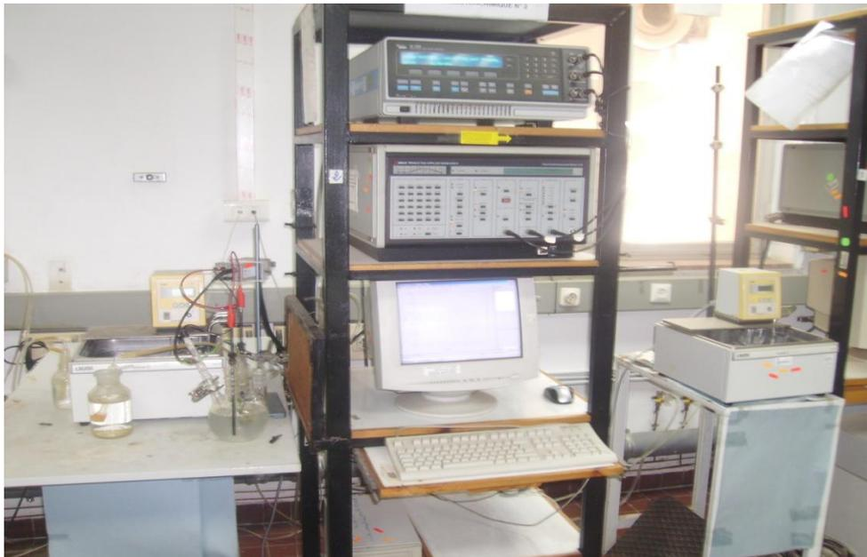
**Figure 33 :** Chaîne de corrosion
