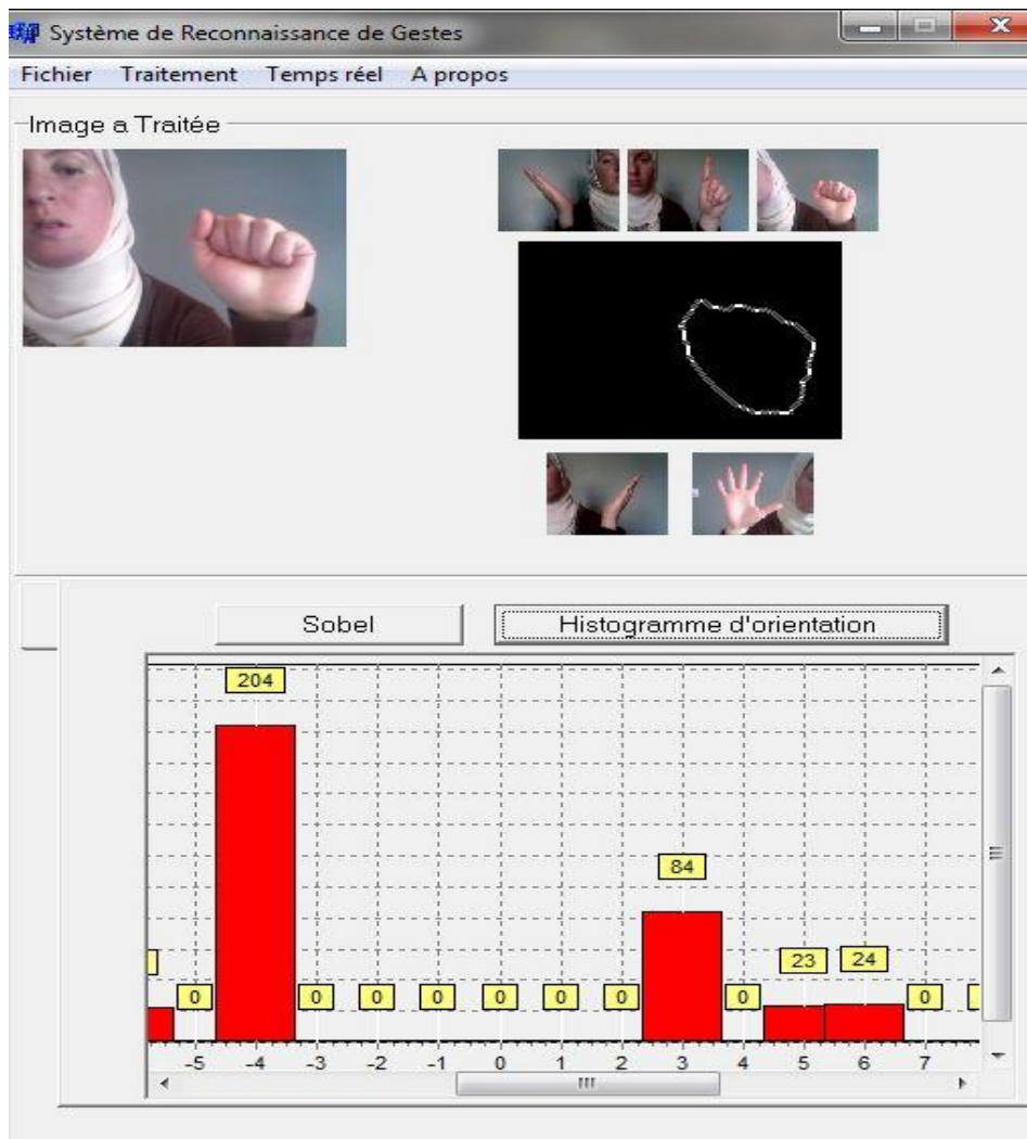
Fig.III.11. Interface d'extraction des caractéristique du geste
