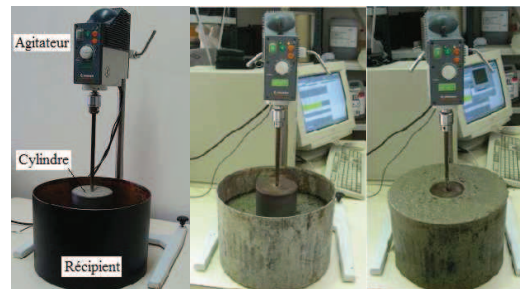
Figure 1. Photo du tribomètre et de la procédure : (a) récipient vide ; (b) récipient rempli jusqu'à mi-hauteur ; (c) remplissage jusqu'à l'arase du récipient.
