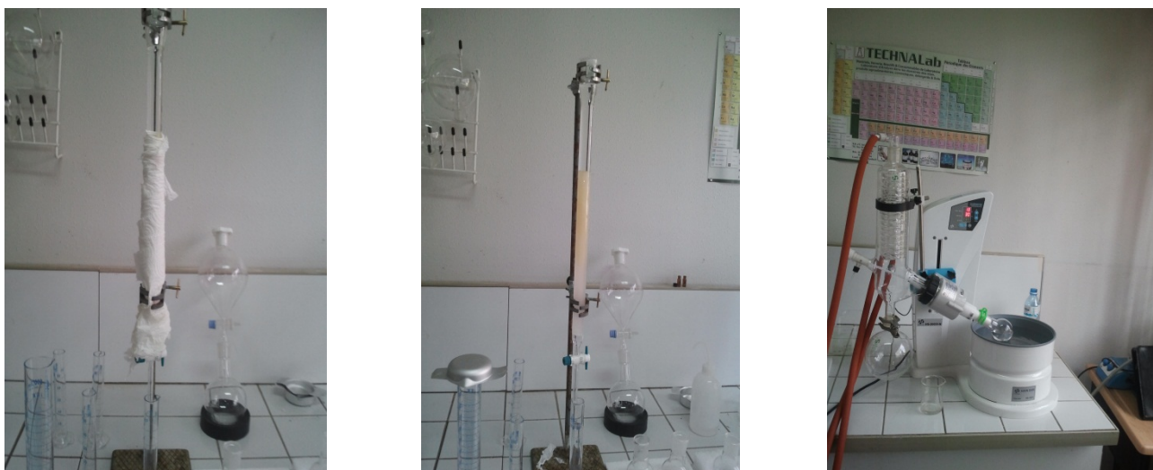
Figure 20 : Fractionnement de l'huile essentielle par colonne chromatographique
