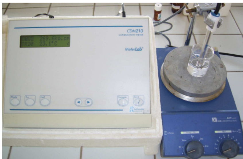
Figure 12 : Conductimètre utilisé avec sa cellule électrolytique
