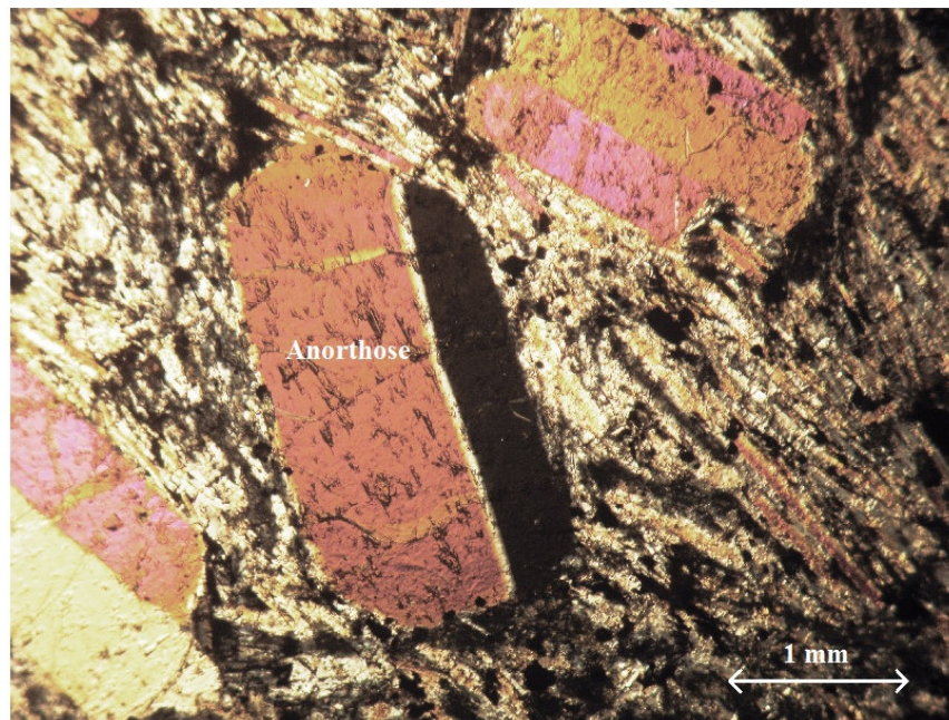
Fig. 41 : Un phénocristal d'anorthose sub-automorphe maclé Carlsbad, vue au microscope par Camera digitale en LPA. Lame TAM 6.
