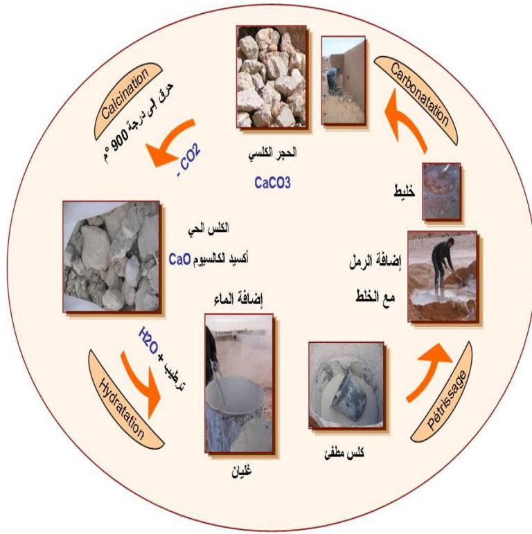
الشكل رقم (42): دورة استغلال الجير عن: (ديوان حماية وادي مزاب وترقيته)
