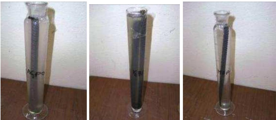
**Figure 3:** Armatures immergées dans les solutions inhibitrices: a) 1M  $\text{Na}_3\text{PO}_4$ , b) 1M  $\text{K}_2\text{HPO}_4$ , c) 1M  $\text{Na}_2\text{PO}_3\text{F}$
