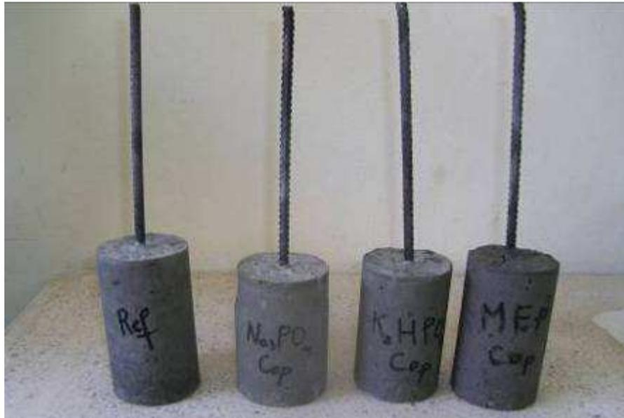
Figure 7: Epreuves en béton armé adjuvanté.
