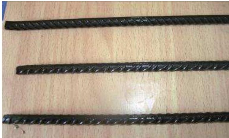
**Figure 2 :** Etat des armatures après décapage des produits de corrosion.
