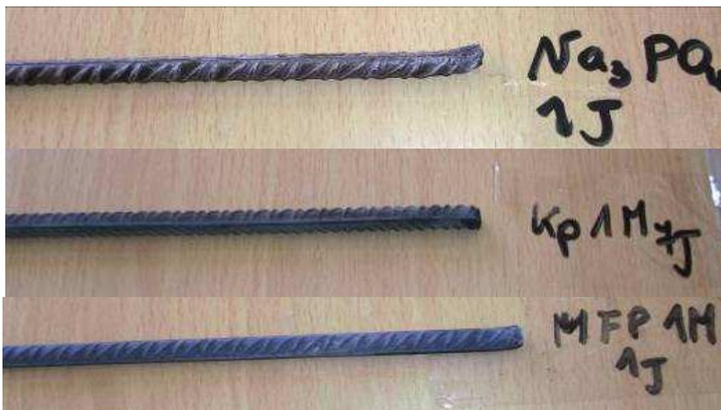
Figure. 8: Armature prétraitée avec 1M Na<sub>3</sub>PO<sub>4</sub>, 1M K<sub>2</sub>HPO<sub>4</sub>, 1M Na<sub>2</sub>PO<sub>3</sub>F
