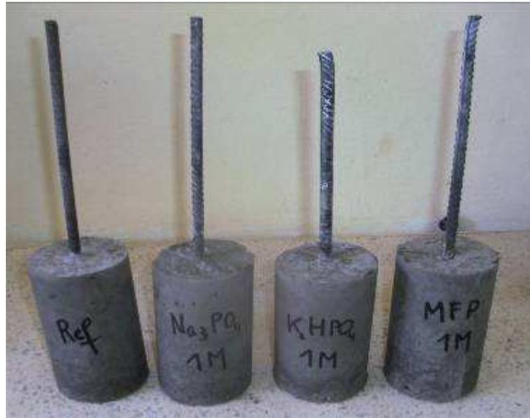
**Figure. 9:** Eprouvettes en béton armé (armatures prétraitées).
