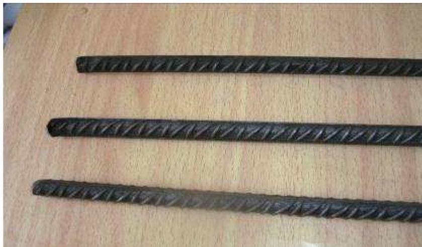
**Figure 5:** Armatures sans prétraitement destinées à la confection du béton adjuvanté.
